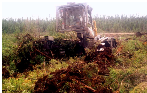
Figure 5. La préparation de terrain, telle que le scarifiage, réduit l'épaisseur de matière organique qui caractérise le processus de paludification.
